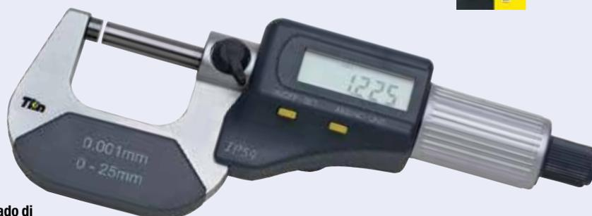
Micrometro digitale con display a cristalli liquidi, **grado di protezione IP 54**, superfici di contatto in metallo duro, struttura in acciaio con guancialini isolanti, leva di blocco, frizione incorporata nel tamburo, precisione secondo norma DIN 863/1.
