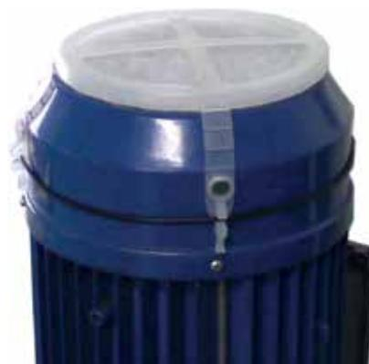
Tessuto filtrante che permette di **proteggere i motori elettrici in genere**, il posizionamento sulla zona di aspirazione del tessuto evita di aspirare all'interno del sistema rotante sporcizia e polveri.
