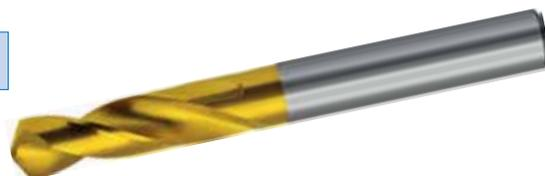
Punta codolo cilindrico in **metallo duro integrale, rettificata**, rivestita TiN, serie extracorta, norma DIN 6539, angolo affilatura 118°.
