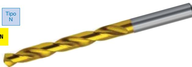
Punta codolo cilindrico in **metallo duro integrale**, **rettificata**, rivestita TiN, serie corta, norma DIN 338, angolo affilatura 118°.
