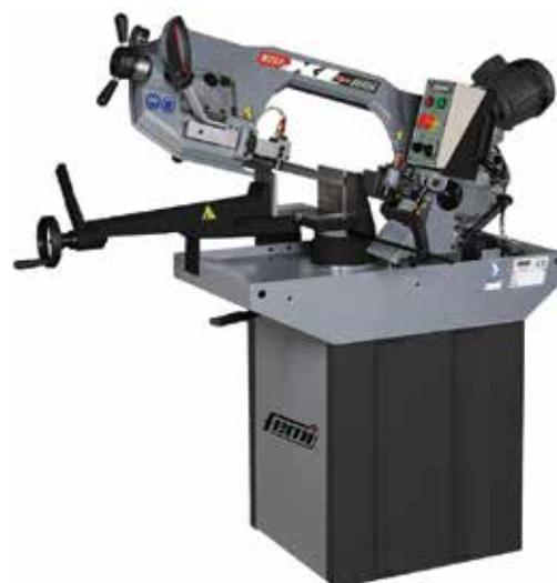
Segatrice a nastro con lama 2480 mm, motore trifase a 2 velocità con motoriduttore a bagno d'olio, braccio, morsa e gruppo girevole in ghisa. Sistema di discesa del braccio tramite cilindro idraulico con regolatore di flusso, guidalama scorrevole in acciaio con cuscinetti. Morsa con sistema di bloccaggio rapido, pompa di lubrificazione con carcassa in alluminio, pressostato indicatore del grado di tensionamento della lama. Leva di sblocco del girevole integrato nel basamento.
