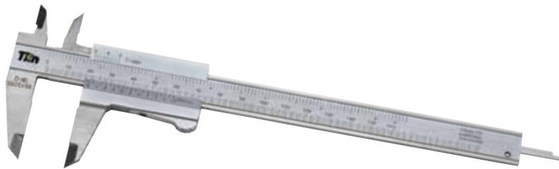
Calibro analogico a corsoio con bloccaggio a leva, struttura in acciaio inossidabile temperato, superfici di contatto rettificate, **parti di lettura cromate satinata, scala principale ribassata** rispetto al nonio, punte incrociate, parte posteriore del nonio con tabella di conversione filetti, precisione secondo norma DIN 862.
