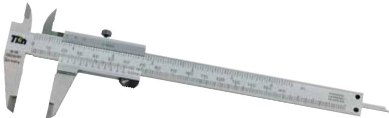
Calibro analogico a corsoio nonio **con scorrevolezza morbida (SOFT-SLIDE) con bloccaggio a vite nella parte superiore**, struttura in acciaio inossidabile temperato, superfici di contatto rettificate, parti di lettura cromate satinata, punte incrociate, parte posteriore del nonio con tabella di conversione filetti, precisione secondo norma DIN 862.
