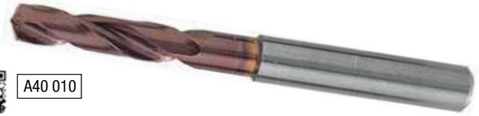
Punta codolo cilindrico in **metallo duro integrale, rettificata**, rivestita FOCUS norma DIN 6537, angolo affilatura 140°, codolo a norma DIN 6535 forma HA. **Per eseguire forature 3xD**, su materiali a truciolo corto e lungo. **Per lavorazioni di acciai legati e non, ghise, leghe di (Al-Si) e acciai inox.**
