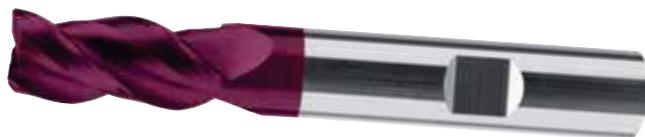
Fresa codolo cilindrico DIN 6535-HB in metallo duro integrale con rivestimento TiALN, a 3 taglienti con angolo evolvente variabile 35/38°, la spaziatura dei taglienti e la particolare spoglia permettono lavorazioni di sgrossatura e finitura con basse vibrazioni, elevata silenziosità, taglio centrale, angolo di raccordo 45°, concentricità <0,01 mm. **Per lavorazioni di acciai inox e leghe di titanio.**
