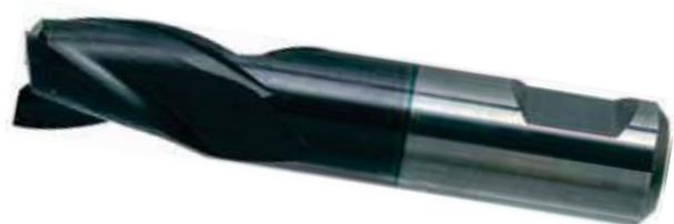
Fresa codolo cilindrico weldon DIN 6535-HB in metallo duro integrale con rivestimento multistrato ENERGY a 3 taglienti, tagliente al centro, elica 30°, spoglia 12°, per esecuzione sedi di chiavette e asole.
