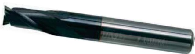
Fresa codolo cilindrico DIN 6535-HA in metallo duro integrale con rivestimento multistrato ENERGY a 2 taglienti, **tagliente lungo 1,5xD**, elica 30°, spoglia 9°, per esecuzione sedi di chiavette e asole.
