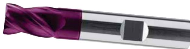
Fresa codolo cilindrico DIN 6535-HB in metallo duro integrale con rivestimento TiALN, a 4 taglienti con angolo evolvente variabile 35/38°, la spaziatura dei taglienti e la particolare spoglia permettono lavorazioni di sgrossatura e finitura con basse vibrazioni, elevata silenziosità, taglio centrale, angolo di raccordo 45°. **Per lavorazioni di acciai inox e leghe di titanio.**
