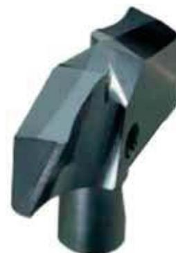
Cuspide in metallo duro intercambiabile per taglio destro, posizionamento preciso con codolo cilindrico di centraggio, bloccaggio con vite centrale e a partire dal  $\varnothing$  12 mm il bloccaggio è doppio, un grano blocca il codolo cilindrico cilindrico, angolo 130°. Per lavorazioni di acciai legati e non, acciaio inox, ghise, alluminio e sue leghe.
