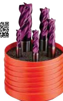
Fresa codolo cilindrico DIN 6535-HB in metallo duro integrale con rivestimento TiALN, a 4 taglienti con angolo evolvente variabile 35/38°, la spaziatura dei taglienti e la particolare spoglia permettono lavorazioni di sgrassatura e finitura con basse vibrazioni, elevata silenziosità, taglio centrale, angolo di raccordo 45°. **Per lavorazioni di acciai inox e leghe di titanio.**
