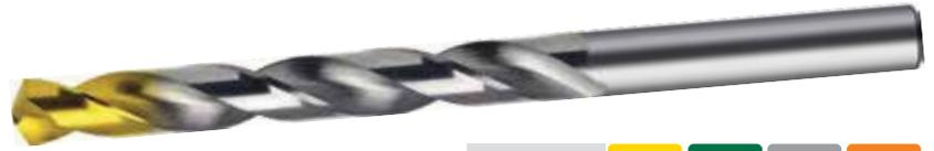
Punta codolo cilindrico in acciaio HSS rivestita TiN solo nella prima parte dell'elica, serie corta, direzione del taglio destro. Per lavorazioni di acciai legati e non, ghise grigie, malleabili e sferoidale.
